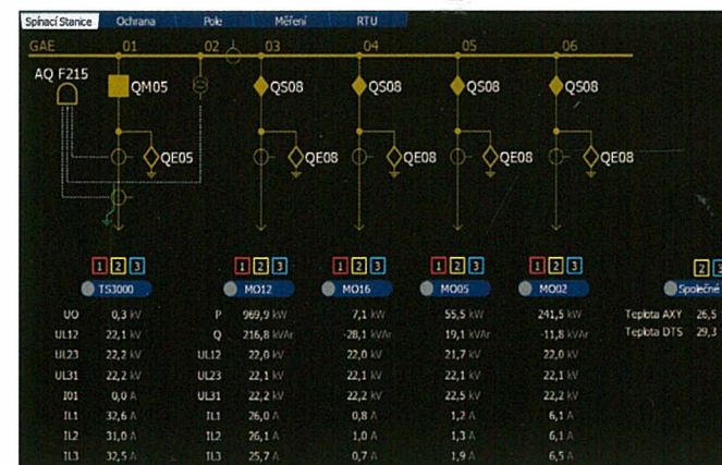
Obr. 3 – Automatizace napájecí stanice LDS
