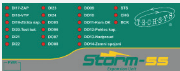
Integrovaný signalizační panel
